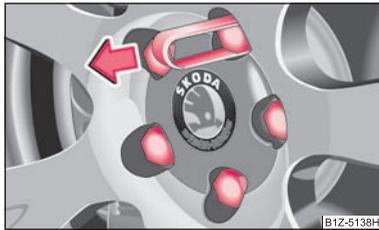
Fig. 176 Dépose du chapeau de roue
