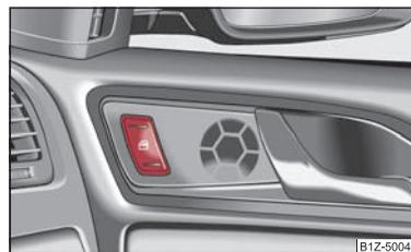
Fig. 34 Disposition de la touche dans la porte du passager avant
