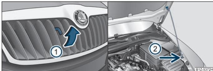
Fig. 161 Calandre: Levier de fixation / Fixation du capot-moteur avec appui du capot
