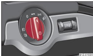
Fig. 7 Tableau de bord: Commutateur d'éclairage
