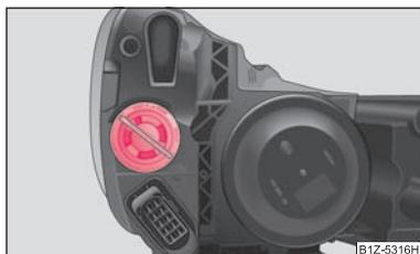
Fig. 191 Dépose de l'ampoule du clignotant avant
