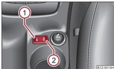
Fig. 26 Console centrale: Touches du verrouillage centralisé
