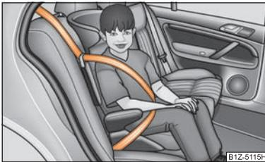
Fig. 145 Siège pour enfant monté sur le siège arrière dans le sens de déplacement selon groupe 2
