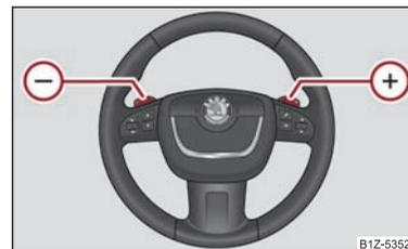
Fig. 119 Volant multifonctions: Enclenchement manuel
