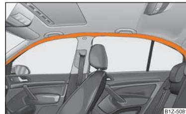
Fig. 138 Emplacement de l'airbag de tête
