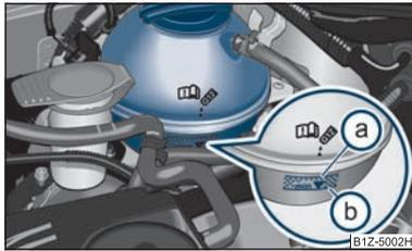
Fig. 164 Compartment moteur: Vase d'expansion du liquide de refroidissement
