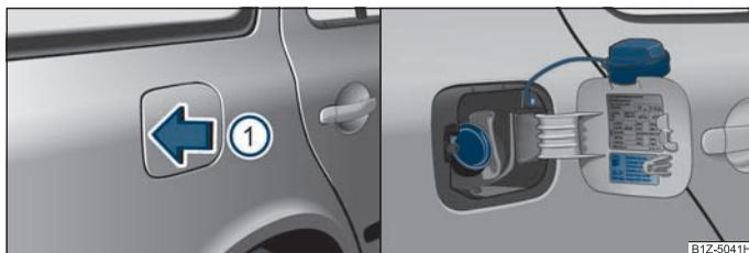
Fig. 159 Côté arrière droit du véhicule: Trappe du réservoir ouverte / Trappe avec bouchon dévissé
