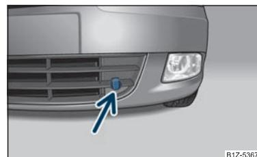
Fig. 158 MultiFuel – Prise de courant
