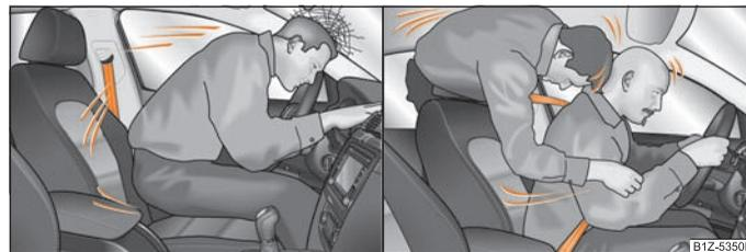
Fig. 129 Le conducteur non attaché part en avant / le passager non attaché sur le siège arrière part en avant
