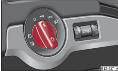
Fig. 37 Tableau de bord: Commutateur d'éclairage
