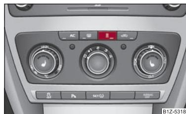
Fig. 109 Touche pour l'enclenchement/arrêt direct du chauffage additionnel (chauffage et ventilation à l'arrêt) sur les touches de commande du Climatic
