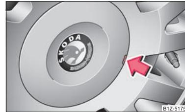
Fig. 177 Déposer l'enjoliveur d'une roue en alliage léger
