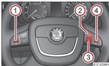
Fig. 124 Volant multifonctions: Touches de commande pour le téléphone
