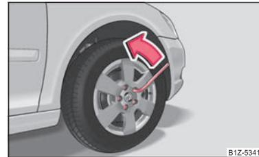
Fig. 178 Changement de roue: Desserrer les boulons de roue
