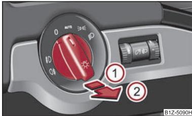
Fig. 39 Tableau de bord: Commutateur d'éclairage
