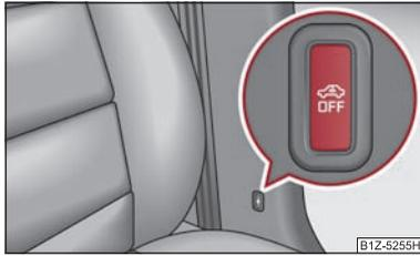
Fig. 32 Touche pour la surveillance de l'habitacle et la surveillance de la protection anti-remorquage
