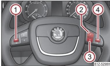
Fig. 125 Volant multifonctions: Touches de commande pour le téléphone
