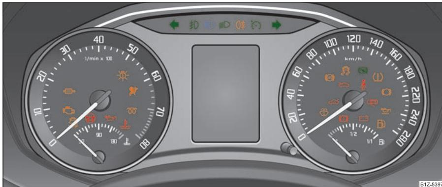
Fig. 21 Combiné d'instruments avec témoins de contrôle
