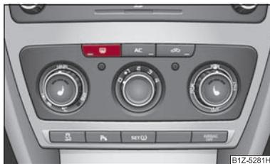
**Fig. 47 Contacteur du chauffage de lunette AR**
