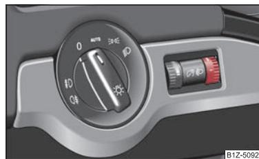
Fig. 41 Tableau de bord: Réglage de la portée des phares
