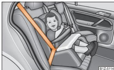
Fig. 144 Siège pour enfant monté à l'arrière dans le sens de déplacement avec tablette de sécurité selon groupe 1
