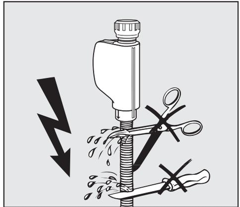
⚠ Risque d'électrocution dû à la tension réseau. Le tuyau d'arrivée contient des éléments sous tension. Le tuyau d'arrivée ne doit pas être raccourci ou abîmé (voir illustration).
