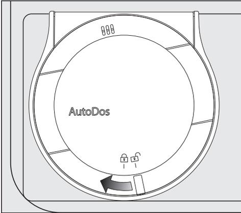
Le détergent en poudre doit être sec pour qu'il ne se solidifie pas. Ne versez pas de liquide dans le système AutoDos.
