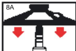
1. Poser le module TIMAX sur la soupape jusqu'à encliquetage du clip, sinon le module TIMAX ne peut pas être programmé (cf. ill. 8A).
