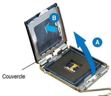
5. Placez le CPU sur le socket, en vous assurant que la marque en forme de triangle doré est placée en bas à gauche du socket. Les ergots d'alignement sur le socket doivent correspondre aux encoches du CPU.
