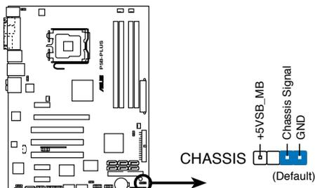
Connecteur Châssis intrusion de la Série P5B Plus
