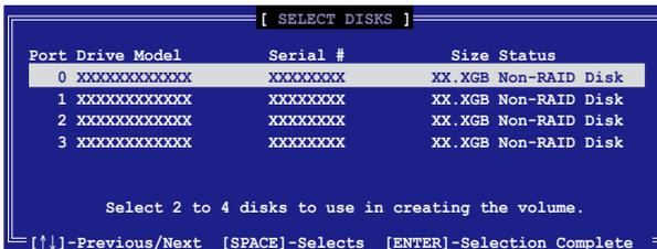
5. Utilisez les flèches haut-bas pour mettre un disque en surbrillance, puis pressez <Espace> pour le sélectionner. Un petit triangle distinguera ce disque. Pressez <Entrée> pour terminer votre sélection.
