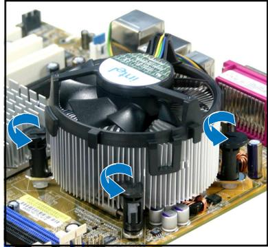
3. Tirez vers le haut deux systèmes de serrage en même temps en séquence diagonale pour dégager l'ensemble dissipateur-ventilateur de la carte mère.
