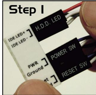
2. Insérez délicatement ASUS Q-Connector sur le connecteur System panel.
