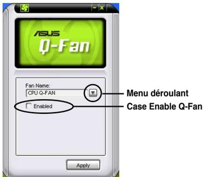
La liste **Profile** apparaît après avoir coché la boîte **Enable Q-Fan**. Cliquez sur le menu déroulant et sélectionnez un profil. Le mode **Optimal** permet aux ventilateurs d'ajuster leur vitesse en fonction de la température; le mode **Silent** diminue la vitesse des ventilateurs pour des opérations silencieuses; le mode **Performance** booste le ventilateur pour atteindre sa vitesse maximale pour un meilleur refroidissement.
